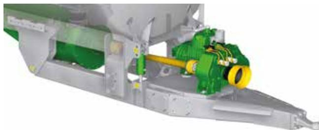
Механический привод через коробку двух насосов
