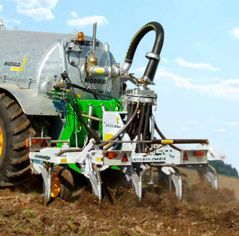
Культиваторные инжекторы TERRASOC укомплектованы жёсткими зубьями, расставленными с интервалом в 40 см, на которых крепится сверхплоская лапа 24 см шириной с защитой срезным болтом. Форма зуба и широкая прорезь в лапе снижают риск забивания. Преимущества этой конструкции:
