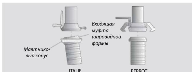
JOSKIN использует 2 типа муфт: "Italie" и "Perrot" (стандарт). Первая отличается небольшим весом и позволяет подсоединять трубу не в полностью выровненной позиции. Муфта Perrot более крепкая, но при этом две части соединения должны быть практически идеально выровнены.
