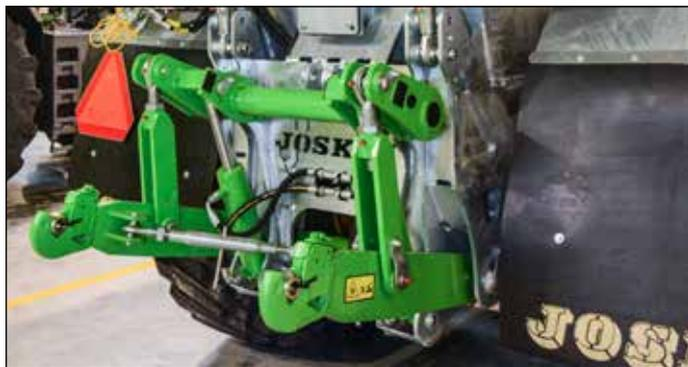
*Встроенный подъёмник Lift на цистерне VOLUMETRA*
