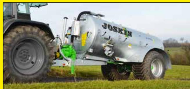
Модели 7100S и 8000S оснащены в стандартной комплектации встроенными пазами для колес. Благодаря этому, возможна установка покрышек шириной 800 мм и диаметром 1500 мм при общей ширине транспортного средства 2,55 см.
