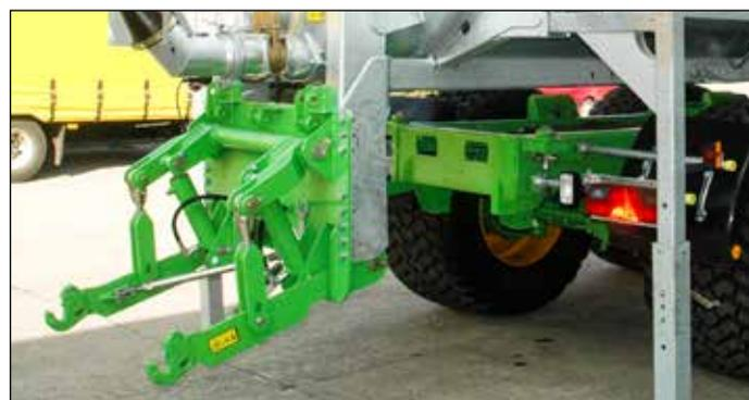
*Подъёмник Low-Lift CARGO на Vacu-CARGO*
