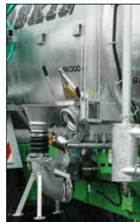
Опора, установленная на шасси
