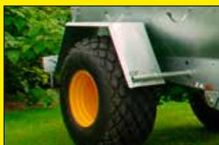
Грязезащитные крылья на одноосной машине **БЕЗ** пазов для колес
