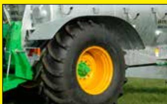
Грязезащитные крылья на одноосной машине **С** пазами для колес
