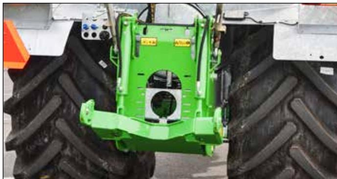
*Подъёмник L600 на шасси COBRA (закреплён на 4 конических пальцах, укрепляющих конструкцию)*
