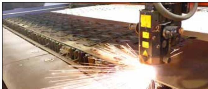
Платформа лазерной резки
