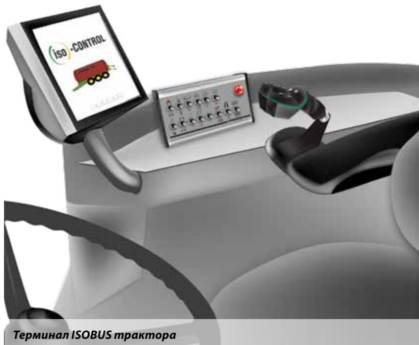
Терминал ISOBUS трактора
