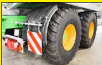
Грязезащитные крылья на Vascu-CARGO с независимыми брызговиками
