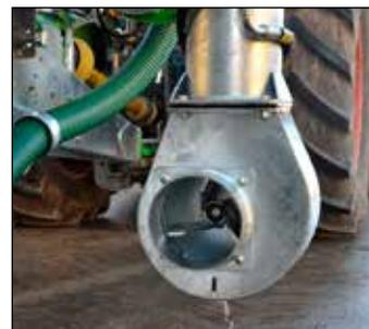
Погружной турбонагнетатель на насосном рукаве
