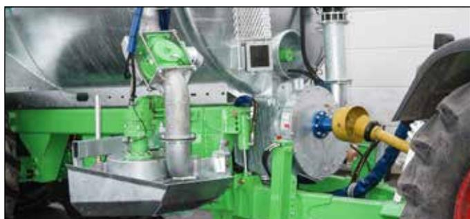
DUAL-STORM с механическим приводом нагнетательного насоса
