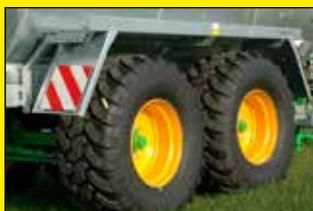
Грязезащитные крылья на двойной оси **БЕЗ** пазов для колес
