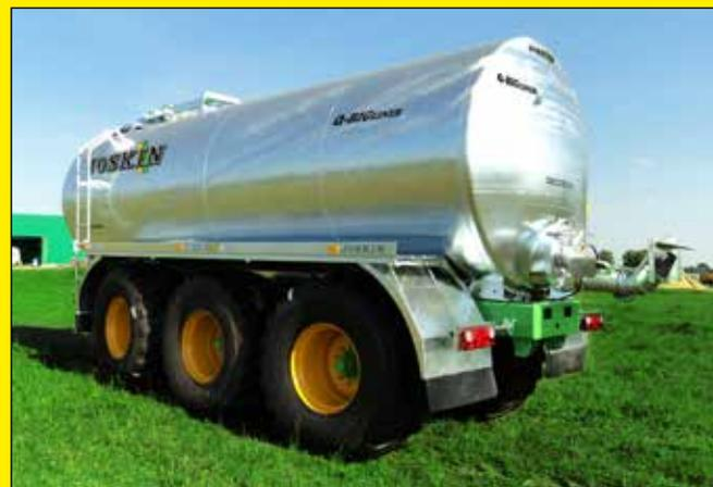
Емкости Q-BIGLINER произведены в соответствии с нормой EN707, как и все остальные модели JOSKIN. Емкости снабжены внутренними перегородками, предотвращающими внезапное перемещение перевозимой жидкости.
